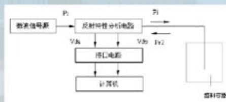
图1 介电特性测试原理示意图
